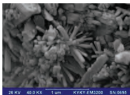
Рисунок 4: Изображение углеродных наностержней, изготовленных из угля в присутствии катализатора наночастиц магнетита ( \text{Fe}_3\text{O}_4 ).
